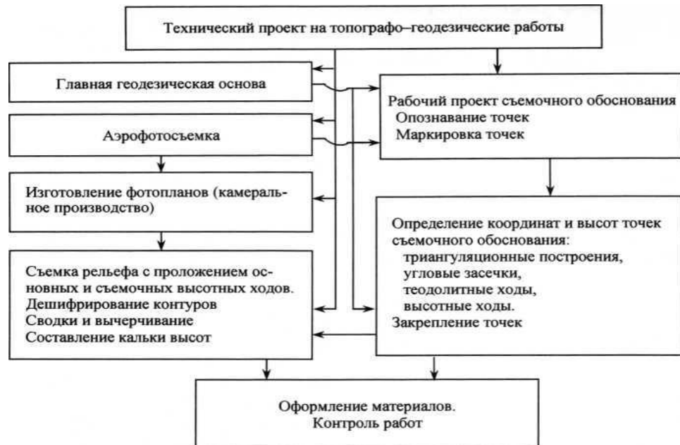
Рис. 2. Технологическая схема полевых работ при комбинированной съёмке
