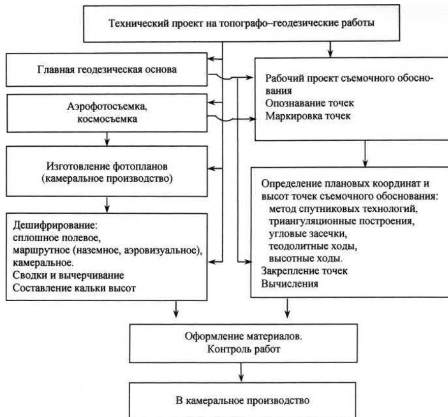
Рис. Е Технологическая схема полевых работ при стереотопографической съемке
