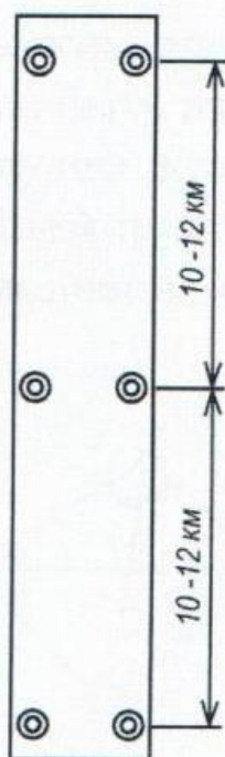
Рис. 10. Схема съемочного обоснования каркасного маршрута
