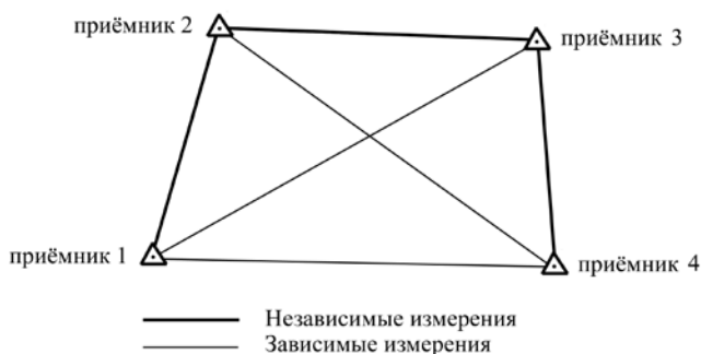
Рис. 2. Схема, иллюстрирующая проект независимого определения 3-х линий из сеанса, выполняемого на 4-х пунктах
